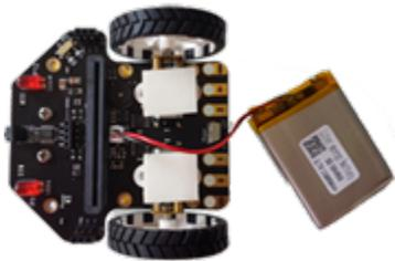
Zusätzlich muss man einen **micro:bit** und drei AA Batterien beschaffen. Wir empfehlen, anstelle der runden Batterien, eine flache **Lipo-Akku**-Batterie (3.7 V, 1.5 Ah) zu beschaffen und diese mit einem doppelseitigen Klebband zu befestigen. Vorteilhaft ist, micro:bit V2 zu verwenden, da dieser mehr Speicherplatz hat.
