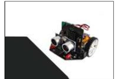
2. Programmiere eine Alarmanlage. Ein Roboter mit einem Ultraschallsensor überwacht einen Raum. Du kannst jederzeit mit deinem Smartphone die Distanz, die er detektiert abfragen.
