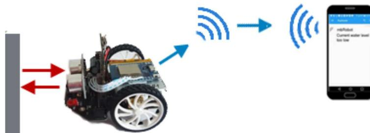
Du übernimmst das Konzept aus dem vorhergehenden Kapitel. Mit deinem Programm wird eine einfache Webseite auf den Roboter hochgeladen. Diese dient aber nicht zur Steuerung des Roboters, sondern zum Anzeigen der Sensorwerte.
