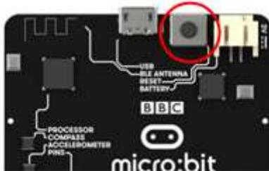
Auf der Rückseite des micro:bits befindet sich ein **Reset**-Button, mit dem das zuletzt heruntergeladene Programm erneut ausgeführt werden kann. Du kannst auch den kleinen Schalter auf "OFF" - und wieder auf "ON" schalten. Dann wird das letzten Programm erneut ausgeführt.
