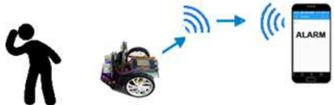
Falls sich ein Objekt näher als 30 cm befindet, schaltet er Alarm ein, wenn das Objekt entfernt, stellt er den Alarm ab.
