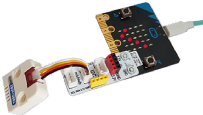
Am micro:bit wird der Sensor mit dem mitgelieferten I2C Kabel über einen **I<sup>2</sup>C-Hub** angeschlossen. Ein solcher Hub kann für Fr. 6.- bei der TigerJython-Group bestellt werden. Für den Versand in der Schweiz wird Fr. 1.-, ausserhalb der Schweiz Fr. 3.- verrechnet.
