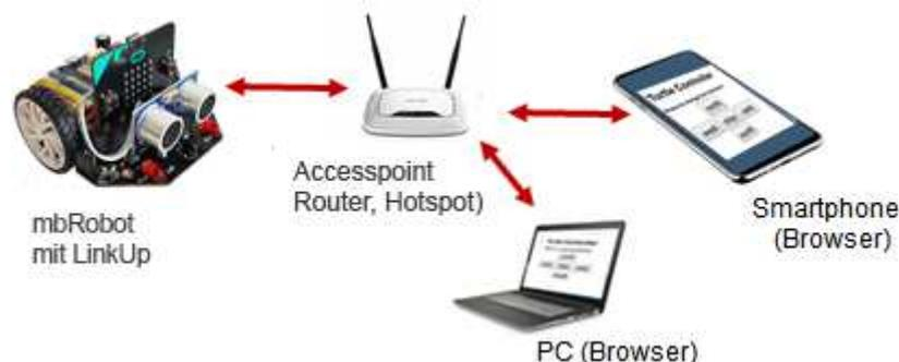
Der mbRobot dient als Webserver, kann Webseiten zur Verfügung stellen und auf die eingehenden Anfragen (**Requests**) der Benutzer (**Clients**) reagieren. Die Clients (Smartphone, PC) können mit einem Webbrowser auf diese Webseiten zugreifen. Die notwendigen Befehle sind im Modul **linkup** enthalten, dieses muss zusätzlich importiert werden.
