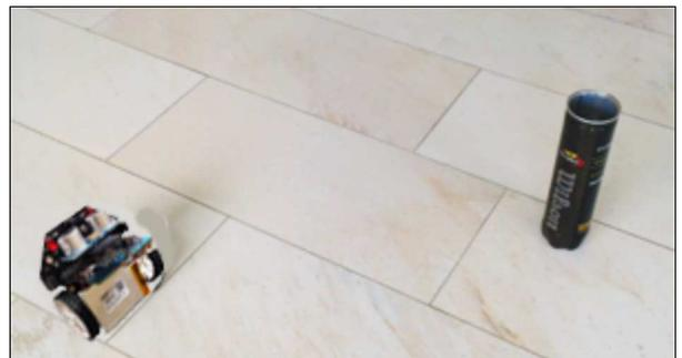
3. Ein Roboter soll gleich wie im Beispiel 2 ein Objekt finden, indem er am Ort dreht und die Werte seines Ultraschallsensors auswertet. Wenn er ein Objekt entdeckt, fährt er hinzu und bleibt im Abstand von 10 cm vor dem Objekt stehen.
