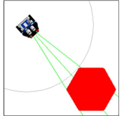
Danach fährt er mit Hilfe einer zweiten `repeat`-Schleife so lange vorwärts, bis die Distanz zum Objekt kleiner als 30 ist. Mit dem Befehl `setBeamAreaColor()` kannst du den Suchvorgang besser veranschaulichen.
