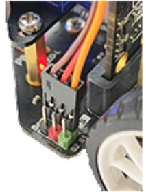
Beim Maqueen Plus V2 wird der Servomotor am **Port P1** bzw. **P2** angeschlossen. Diese befinden sich hinten rechts auf dem Chassis. Im deinem Programm musst du die Servo-Ports im Befehl `setServo()` mit P1 bzw. P2 (statt S1 bzw. S2) aufrufen.
